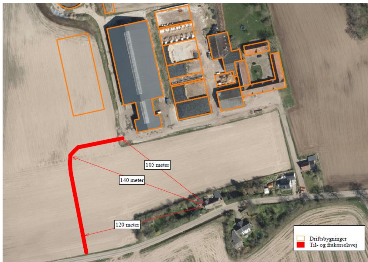
Figur 4. Ny adgangsvej til / fra Bøgeskovvej 61 med angivelse af afstand til Bøgeskovvej 57. De indtegnede driftsbygninger er fra miljøgodkendelse 2018 og er ikke relevante.
