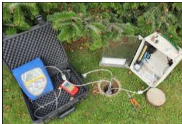
Billede 2: Prøveopstilling med pumpe, differens-tryk- og gasmåler tilkoblet boringen
