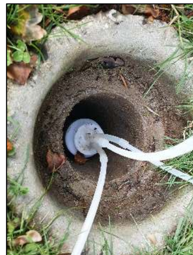
Billede 1: modificeret prop monteret på top af filterrør
