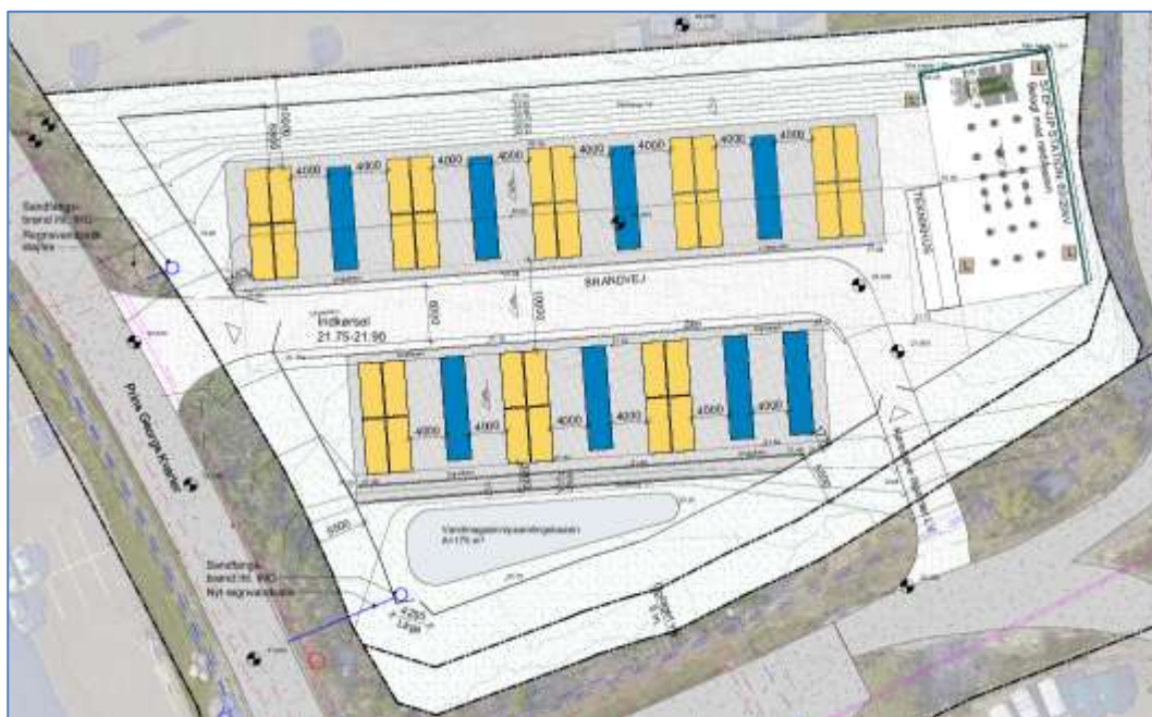
Gul markering: BESS containere. Blå markering: Mellemspændingsanlæg.
