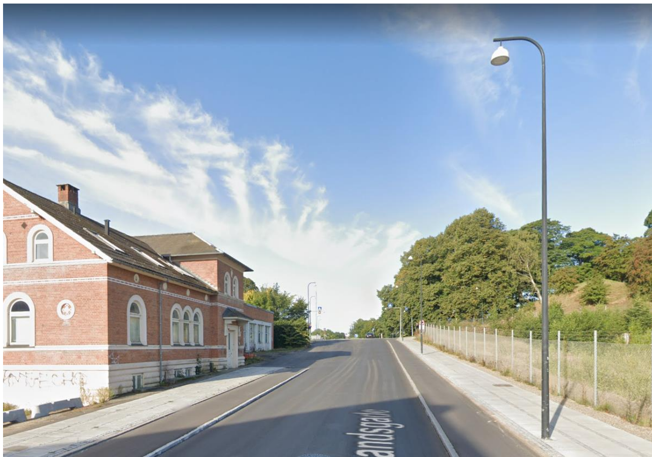
Trafikvej indenfor Volden – 8 m koniske master med Københavner monteret på "stilk", masteplacering i bagkant cykelsti, malet mast. Fremover anvendes standard buetarm.
