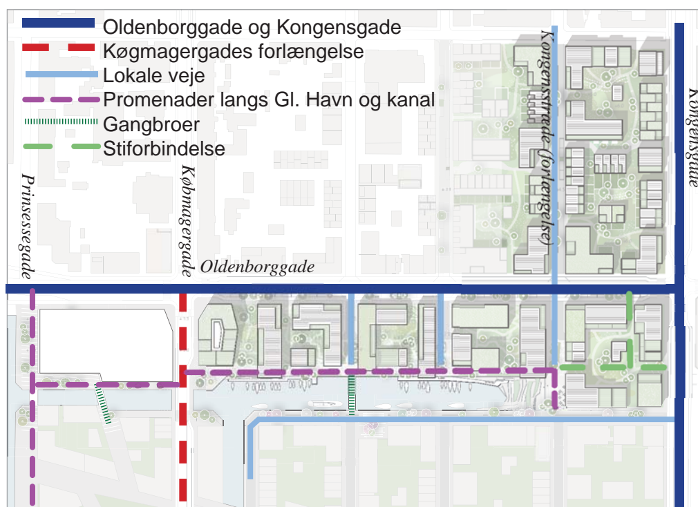
Trafikdiagram - trafikstruktur i lokalplanområdet og betjening af byggefelterne, når området ved Oldenborggade er udbygget
