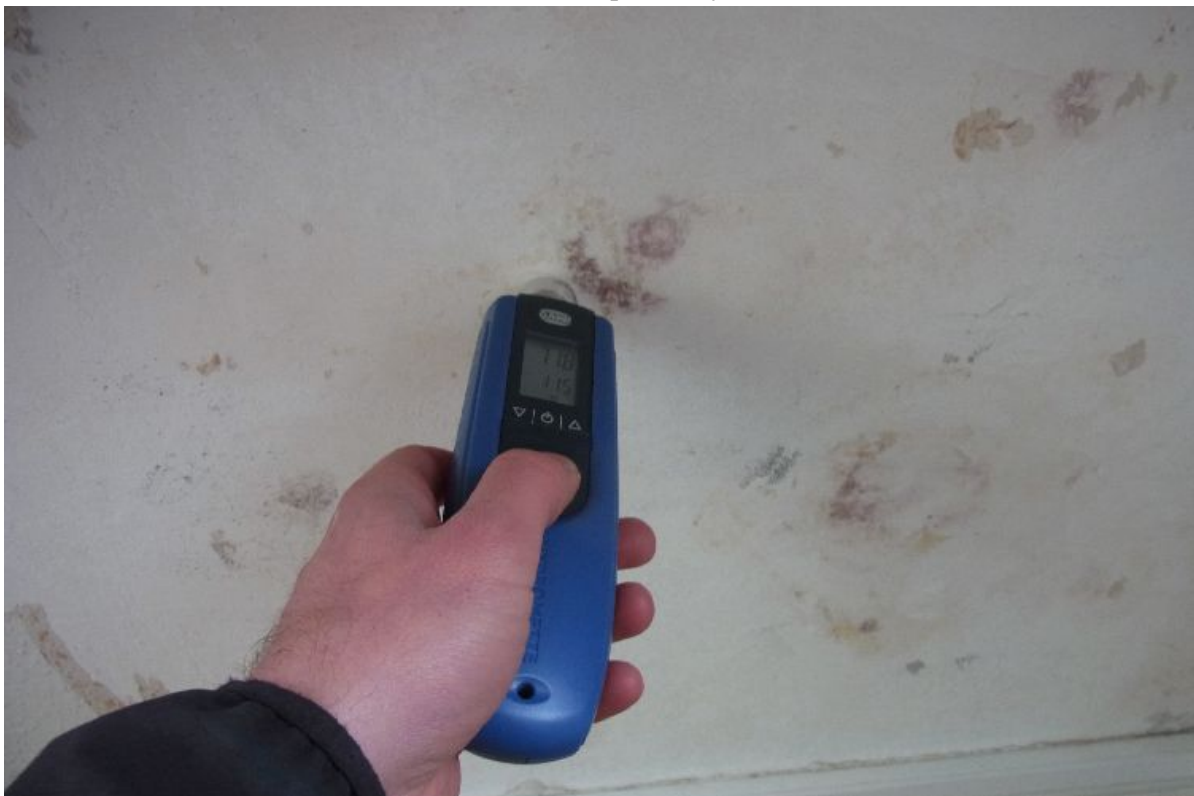
Fugtmåling på 71 digits i karnap
