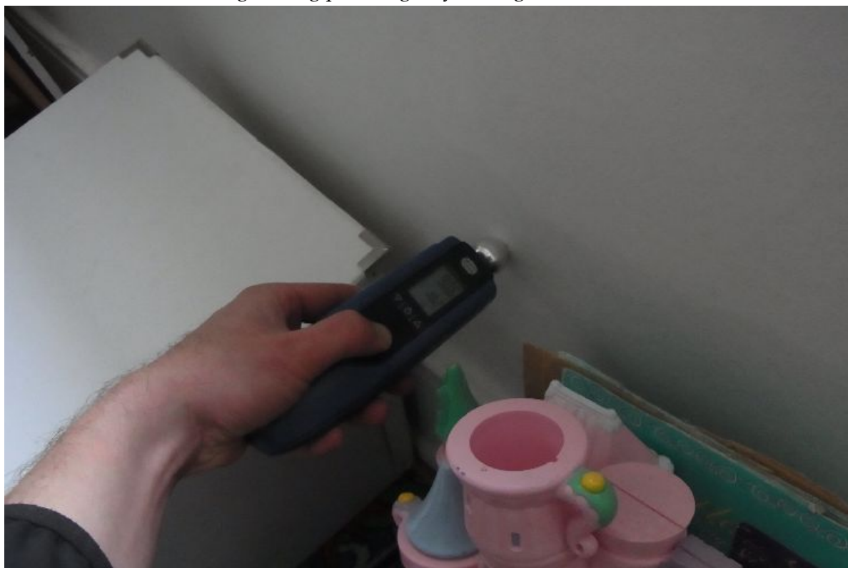
Fugtmåling 90 digits, ydervæg legeværelse
