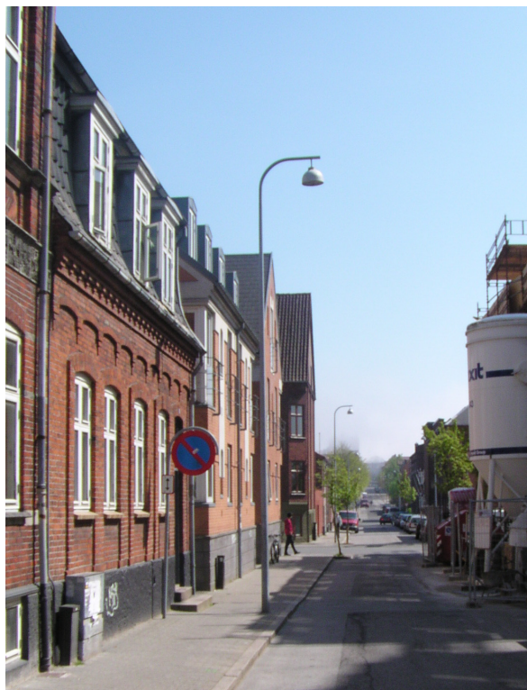
Københavnarmatur på galvaniseret konisk mast med buet arm
