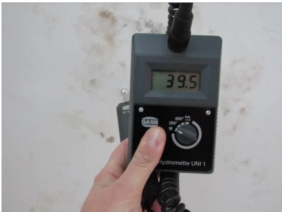
#21 Fugtmåling af de pudsede lofter viste let opfugtning med 40 Gann digits. (referencemåling viste ca. 30 Gann digits)
