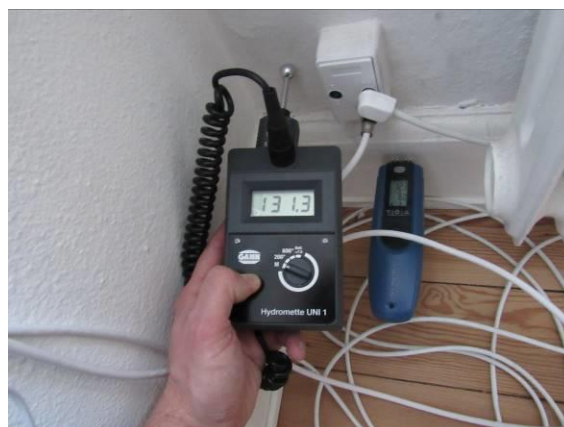
#40 Fugtmåling af tung ydervæg viste over 130 Gann digits (meget fugtig). Fugtmåling af fodpanel viste 12% træfugt (tør).
