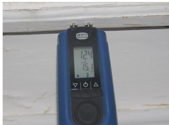
#24 Fugtmåling viste 12-13% træfugt (tør).
