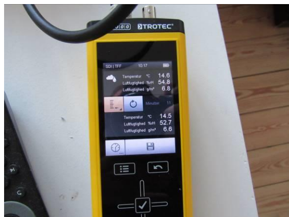
#16 Måling vist 15 o Celsius, 55% relativ luftfugtighed og 6,8g fugt/m 3 luft.
