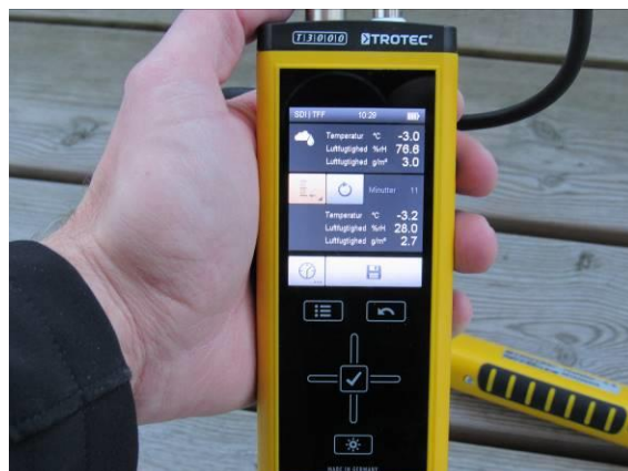
#18 Måling vist -3 o Celsius, 77% relativ luftfugtighed og 3,0g fugt/m 3 luft.
