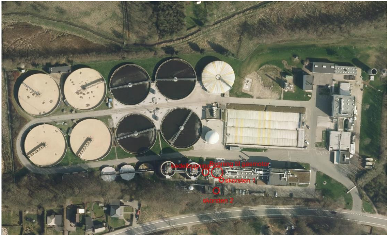
Figur 2, placering af gasmotor, kedelbygning samt skorsten 1 og 2.
