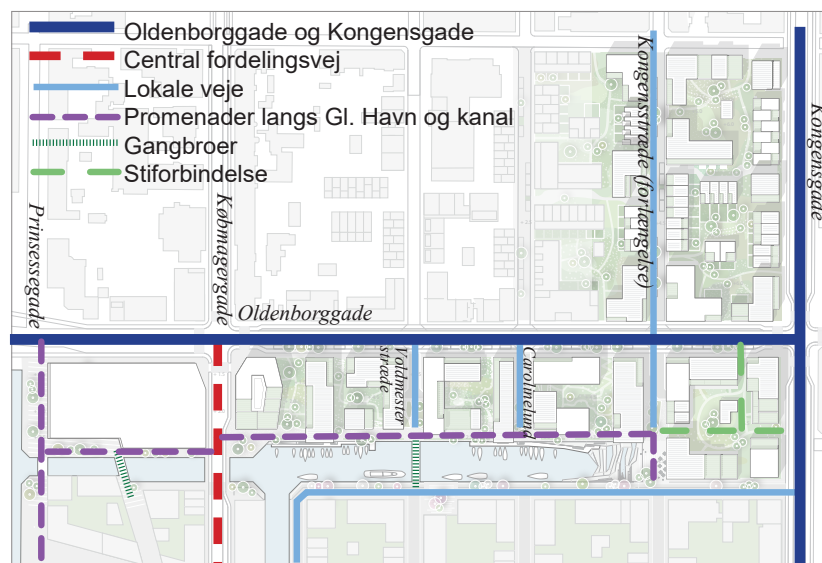
Diagrammet viser lokalplanområdets trafikstruktur og betjening af byggefelter når området ved Oldenborggade er udbygget.
