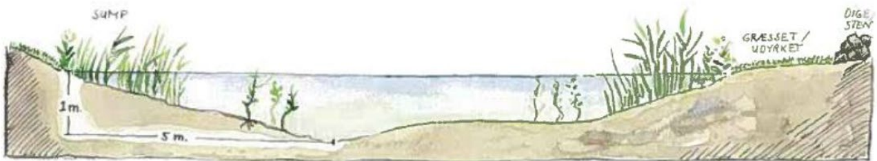
Figur 4. Principskitse af en sø profil med et anlæg på 1:5.
