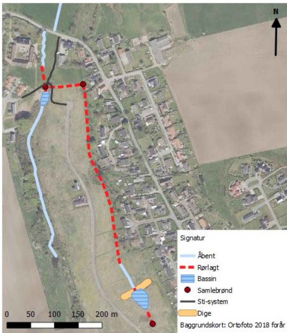
Figur 2: De projekterede forhold for projektområdet, med de to nye bassiner (blå skraveret), afværgedræn (mørk rød) og åbne vandløb (blå) samt dige (brun).
