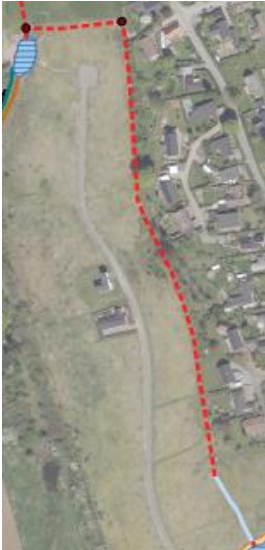
Figur 6: Vandet fra den sydøstlige del af projektområdet ledes via en åben grøft (blå linje) og et afværgedræn (rød stribet linje) ud i en samlebrønd i den vestlige del af projektområdet (rødt punkt). Baggrundskort: Ortofoto forår 2018
