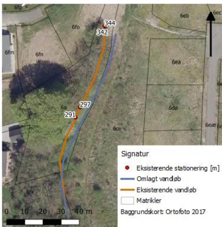
Figur 8: Det eksisterende vandløb mod vest fyldes op og flyttes mod øst, så det bliver synligt fra stien.
