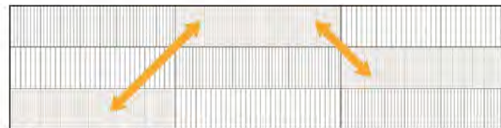
2) Felternes overflader varieres, så trælamellerne har forskellig bredde, dybde og afstand. Felternes variation tydeliggør facadens underopdeling og får facaden til at fremstå mindre massiv.
