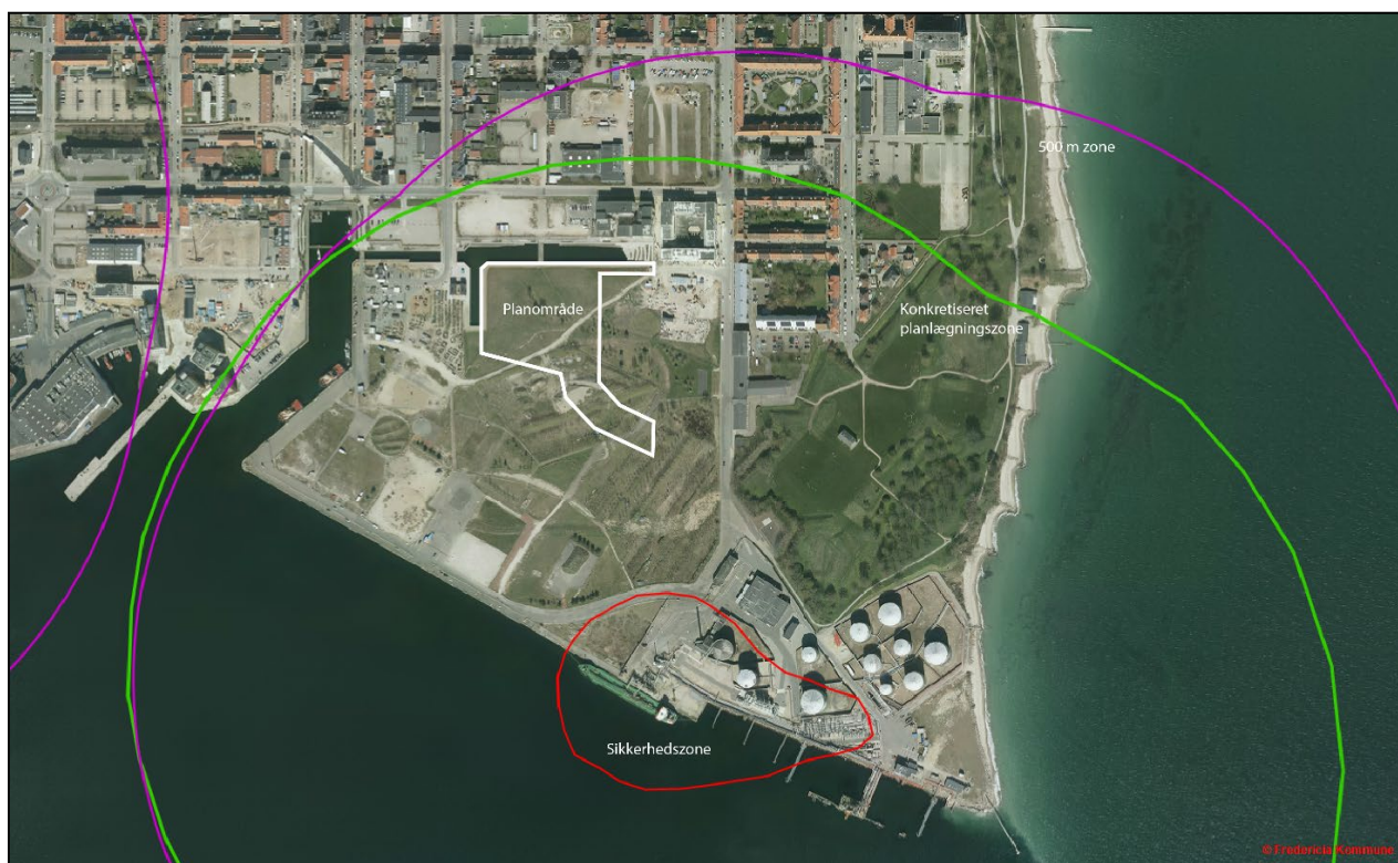
Figur 7: Planlægningszone 500 meter (lilla), konkretiseret planlægningszone (grøn) og sikkerhedszone for risiko (rød) i forhold til Shell Havneterminal. Planlægningszonen omfatter hele lokalplanens område.
