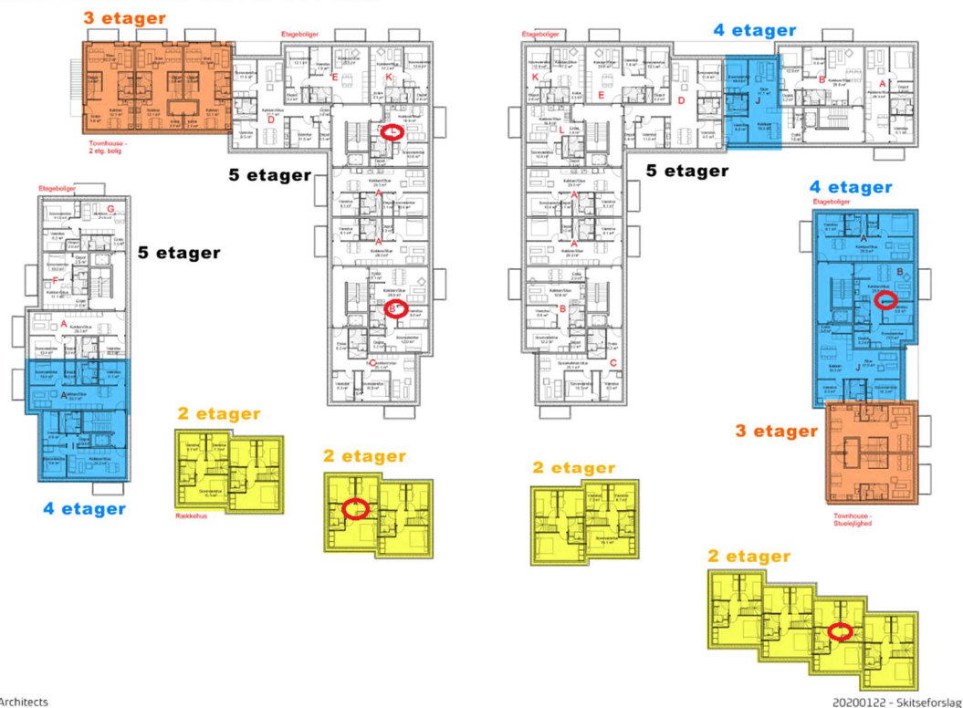
Figur 20: Boliger med støjproblem er markeret med rød oval figur.
