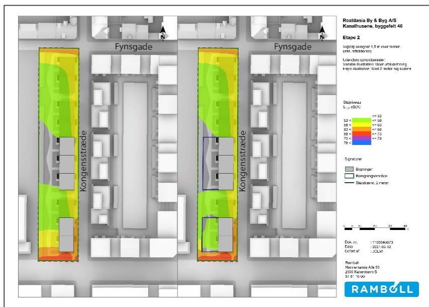
Figur 8: Illustration af støjens udbredelse på projektgrunden for etape 2. Udendørs opholdsarealer udgøres ved etape 2 af gårdrummet, der omkranses af støjskærmene på højre del af illustrationen.
