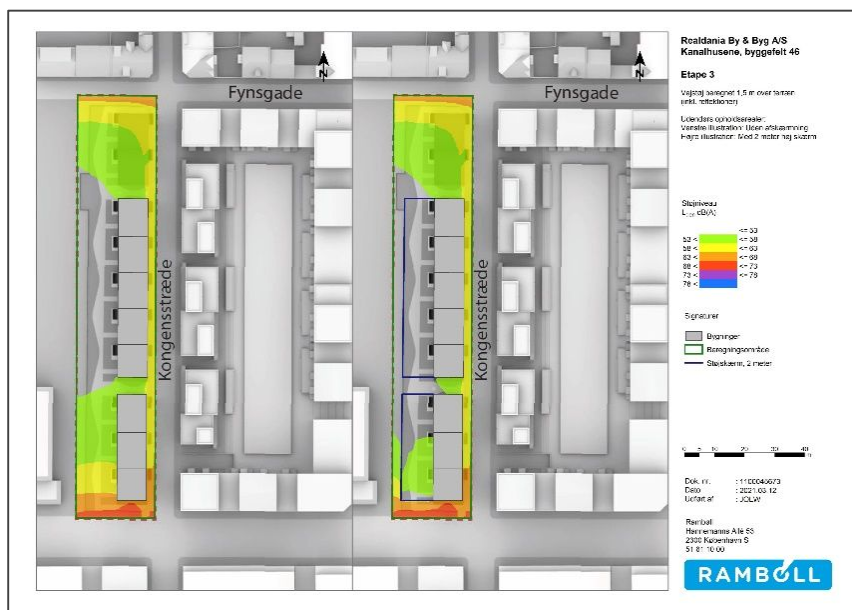
Figur 10: Illustration af støjens udbredelse på projektgrunden for etape 3. Udendørs opholdsarealer udgøres ved etape 3 af gårdrummet, der omkranses af støjskærmene på højre del af illustrationen.
