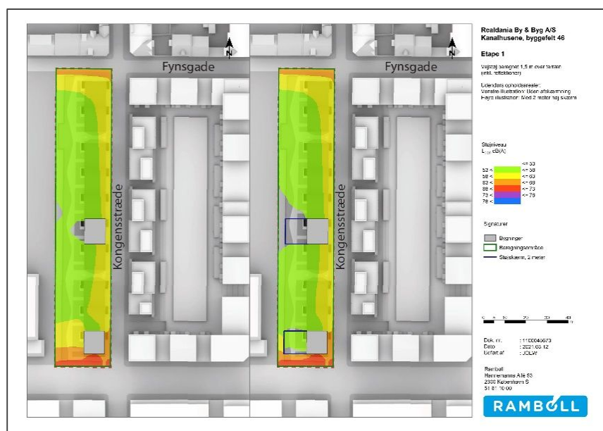
Figur 6: Illustration af støjens udbredelse på projektgrunden for etape 1. Udendørs opholdsarealer udgøres ved etape 1 af gårdrummet, der omkranses af støjskærmene på højre del af illustrationen.
