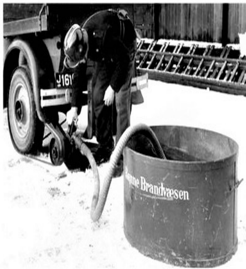
Ellehammers pumpe monteret på bagakslen af en Ford, drevet af baghjulet, ved Rønne Brandvæsen. Det højre hjul på jorden det står stille og på grund af bagakslens differentiale vil kun det venstre rotere hurtigt rundt og med remmen drive pumpen.
