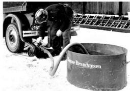
Ellehammers pumpe monteret på bagakslen af en Ford, drevet af baghjulene, ved Rønne Brandvæsen. Det højre hjul på jorden det står stille og på grund af bagakselens differential vil kun det venstre rotere hurtigt rundt og med remmen drive pumpen.
