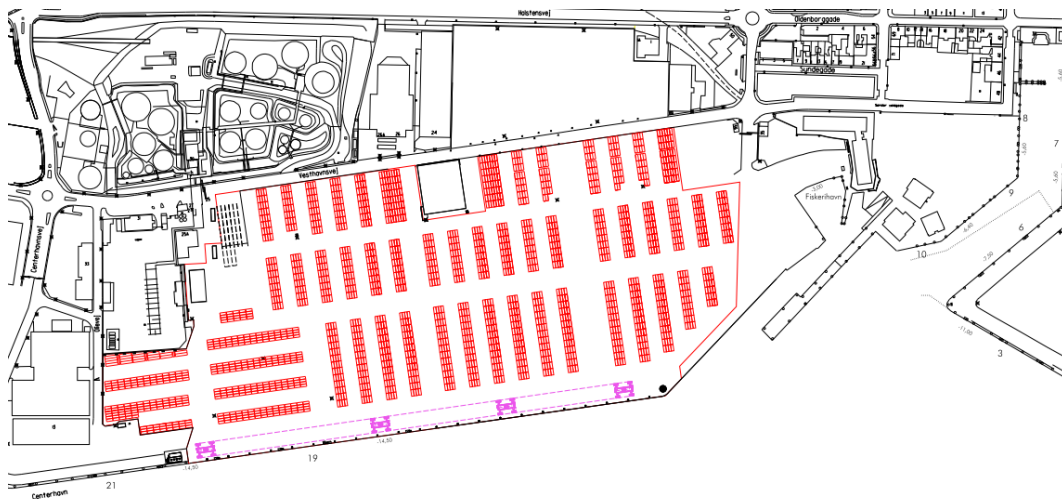
Figur 6 Forlængelse af kaj 19 og etablering af containerplads på de bagvedliggende arealer. Der opstilles to kraner på den forlængede kaj. Støtvæg mod Fredericia indtegnet med rød streg langs den østlige afgrænsning af projektet.
