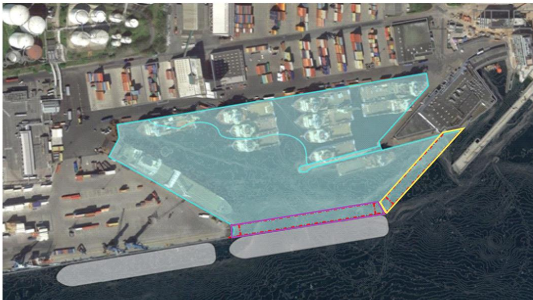
Figur 9 Plan over projektområdet. Den planlagte Kaj 19 forlængelse er angivet med lilla og fløjvæggen er vist med gul.
