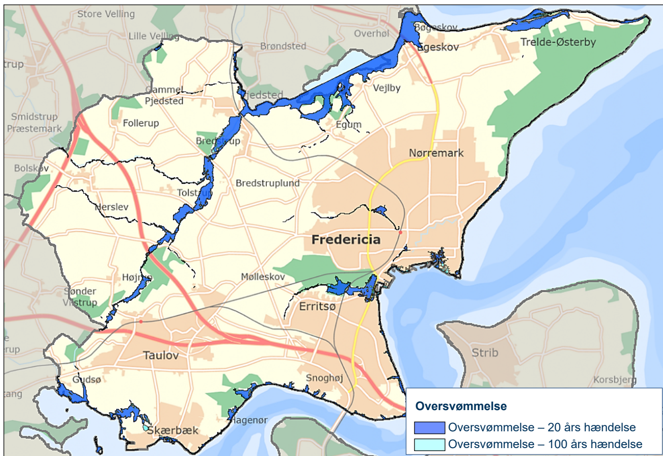
Figur 12. Oversvømmelse på grund af hav- og vandløbsstigninger i 2050 (RCP4.5).
