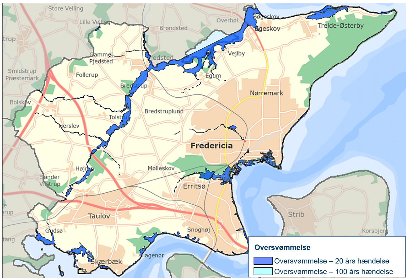
Figur 13. Oversvømmelse på grund af hav- og vandløbsstigninger i 2100 (RCP8.5).
