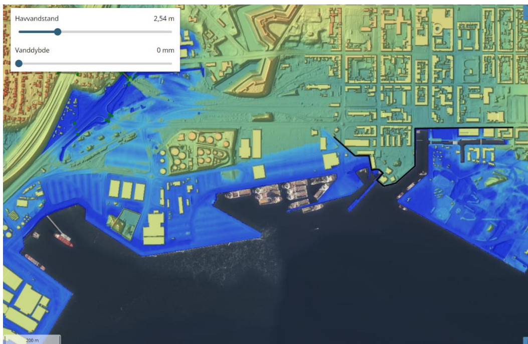
Figur 10.6: Oversvømmelse af Fredericia baseret på højvande til kote 2,5 m DVR90 efter etablering af højvandssikring Kanalbyen til arealerne bag Kaj 19 umiddelbart vest for Norgesgade.
