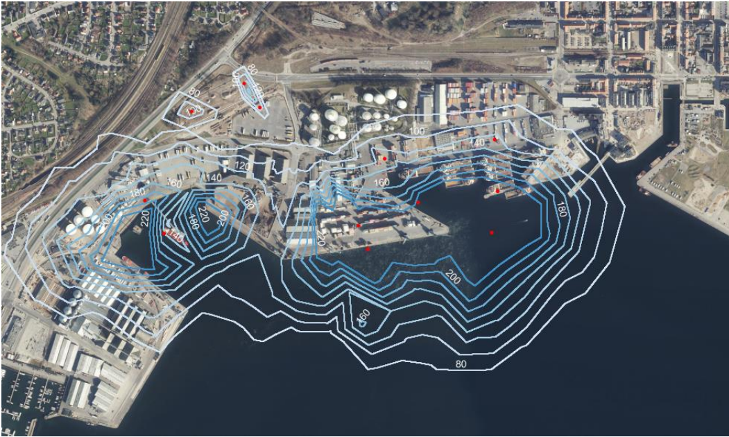
Figur 8.34: Driftsfase: 19. højeste timemiddelkoncentration af \text{NO}_2 i \mu\text{g}/\text{m}^3 . De røde cirkler markerer placering af emissionskilderne.
