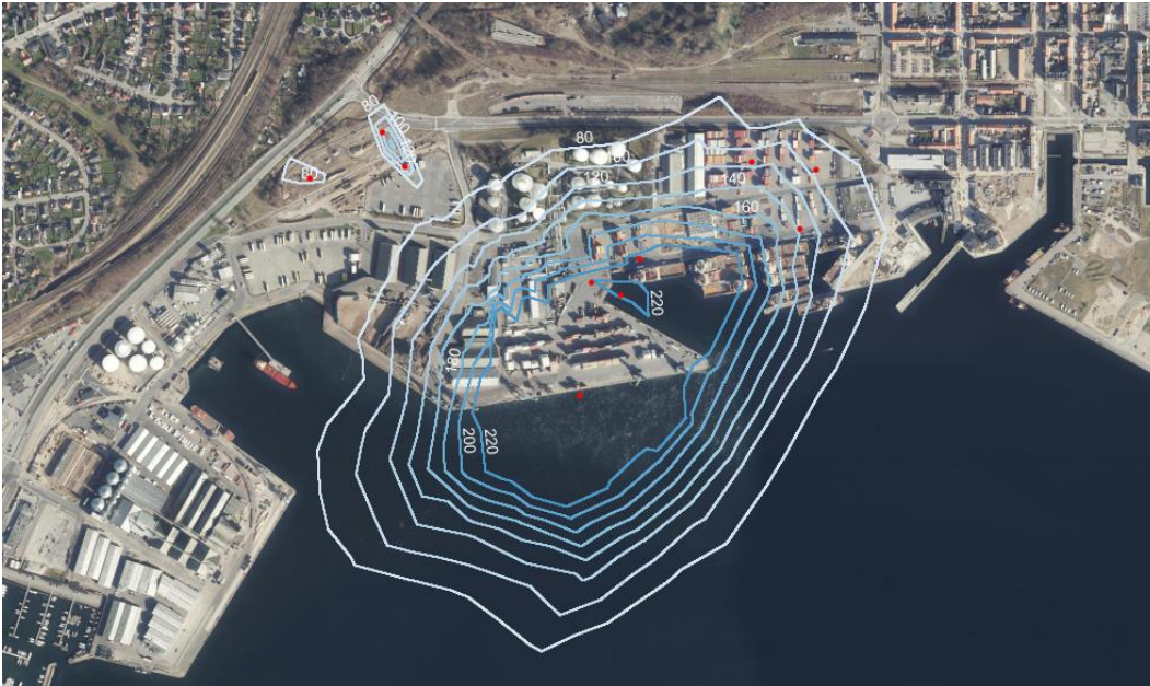
Figur 8.35: 0-alternativ: 19. højeste timemiddelkoncentration af NO 2 i µg/m 3 . De røde punkter markerer placering af emissionskilderne.
