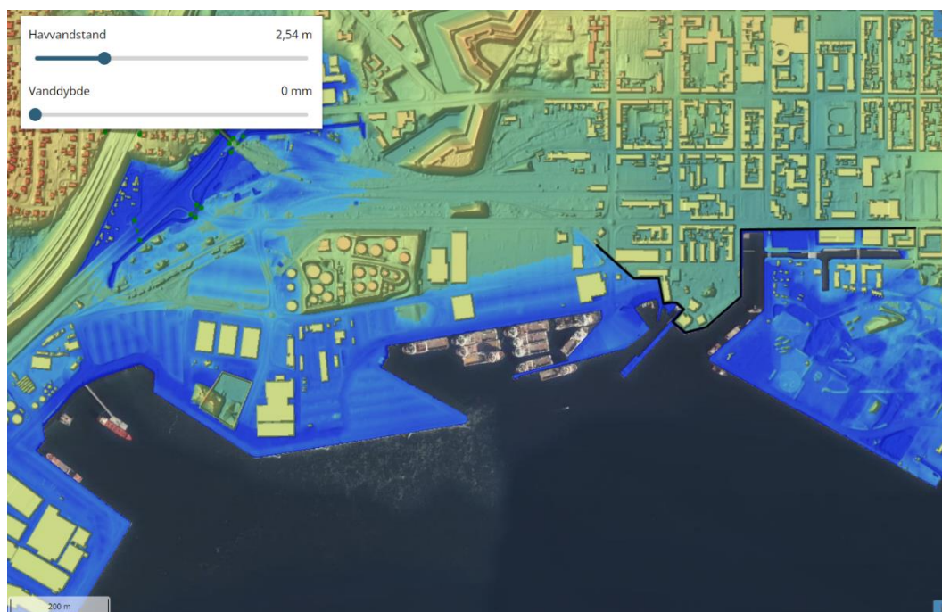
Figur 18-8: Oversvømmelse af Fredericia baseret på højvande til kote 2,5 m DVR90 efter etablering af højvandssikring Kanalbyen til arealerne bag Kaj 19 umiddelbart vest for Norgesgade.
