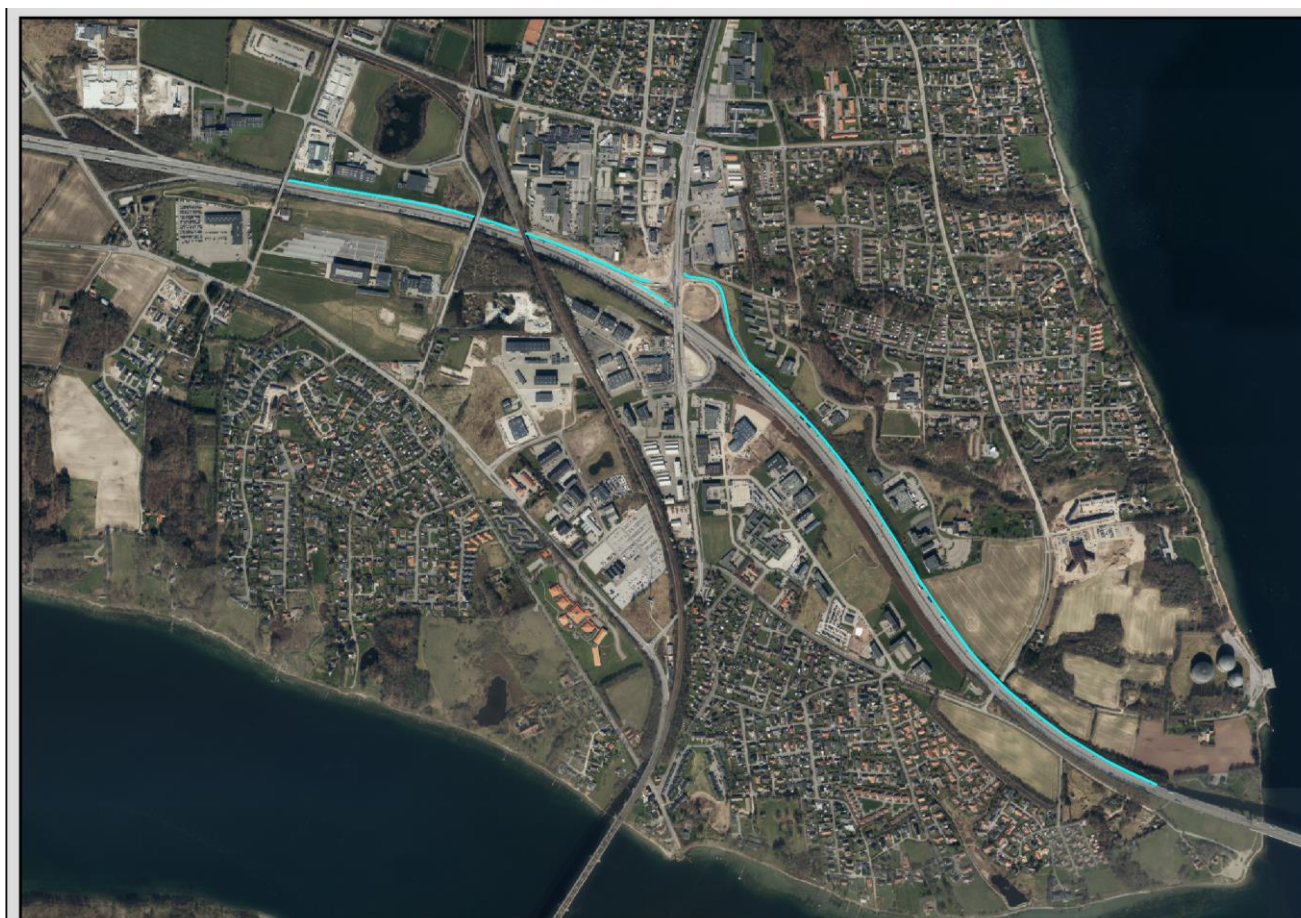
Figur 7.3: Forslag til støjskærme ved Erritsø (område 3) mellem Tonne Kjærvej og Lillebæltsbroen. Skærmen har en samlet længde på 3130 meter.
