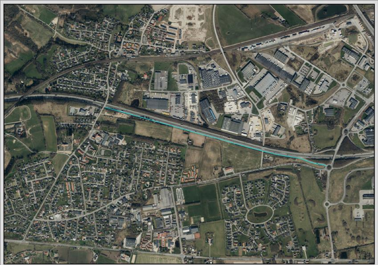
Figur 7.2: Forslag til støjskærm ved Taulov syd (område 2) mellem Taulov Kirkevej og Skærbækvej. Skærmen har en længde på 1650 meter.
