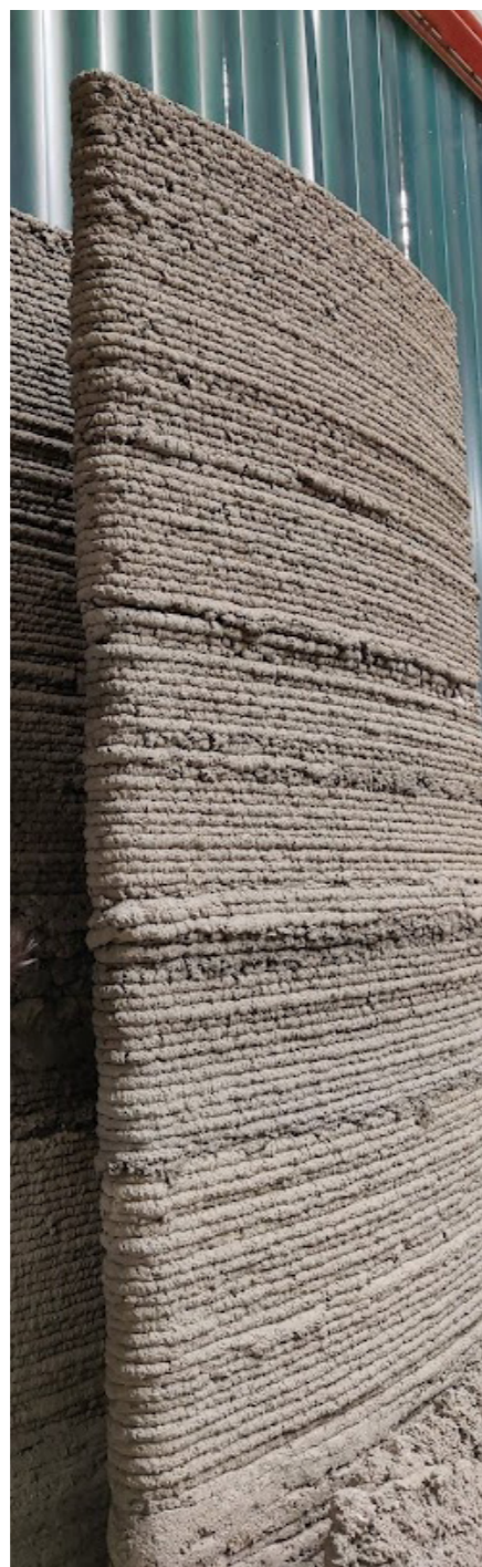
Søjer Første testprint af 3d printet søjle i beton m. FutureCEM
