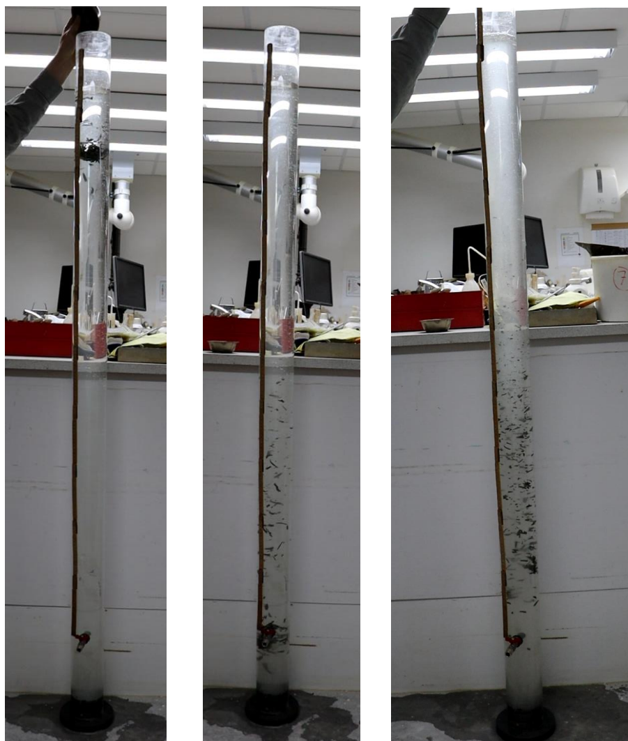
Figur 4-11: Test udført med Andresenrør. 43 g Lillebæltssler er revet i 4 mm tykke flager og hældes i et rør med 1,9 m vandsøjle bestående af vand fra Lillebælt. Billede 1 og 2 er umiddelbart efter at det er hældt i røret, billede tre er efter at røret vendes med bunden i vejret og alt materiale igen synker gennem vandsøjlen.
