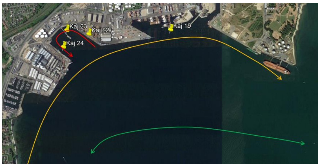
Figur 14-18: Det primære strømningssbillede for Kaj 23 og ud mod strømmen i Lillebælt, hvor rød markerer strømningerne inde ved Kaj 23, orange markerer de langsgående strømninger ved kysten og den grønne viser strømmingen i Lillebælt som nord- eller sydgående.
