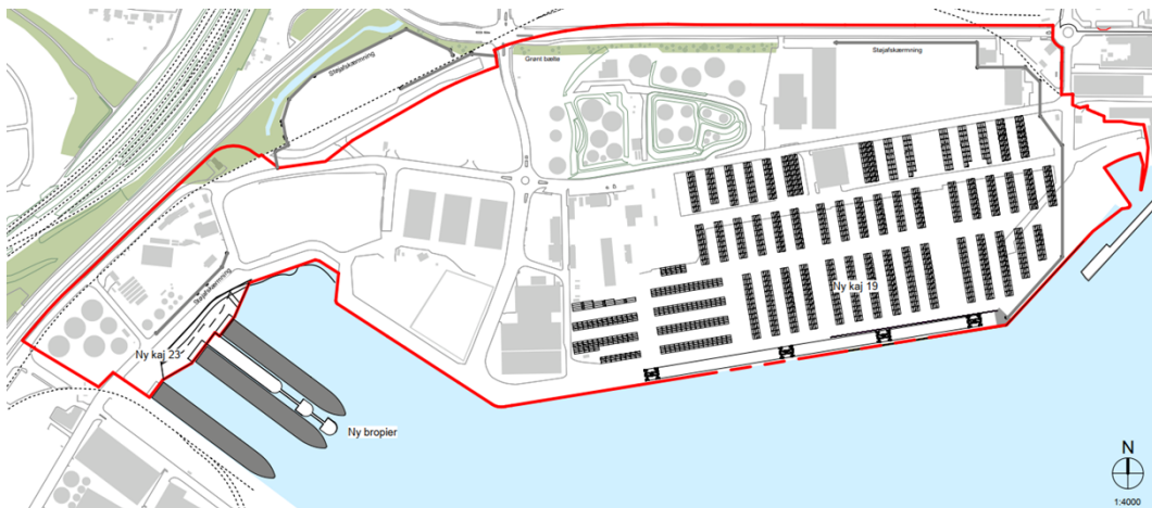
Figur 0.2: De fremtidige forhold med udvidelse af Kaj 19 til højre og ny kaj og pier ved Kaj 23 til venstre.
