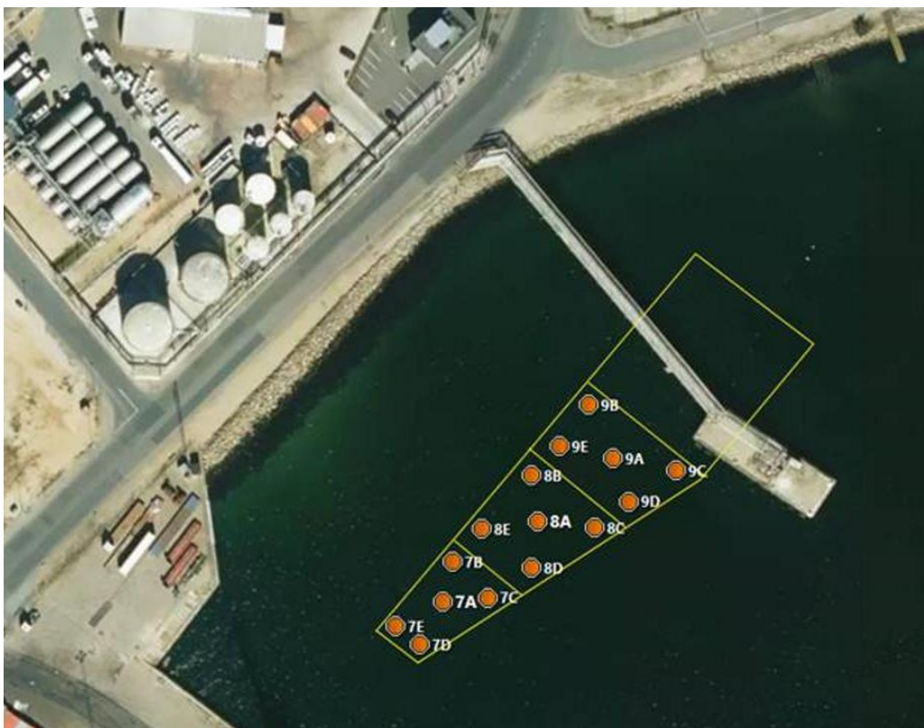
Figur 14-4: Supplerende prøvetagning til bestemmelse af TBT-indhold i sediment ved Kaj 23.
