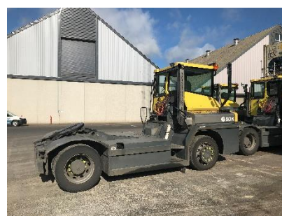
Figur 3-3: RO/RO-transporten til og fra skibe håndteres af MAFI-vogne og terminaltraktorer.
