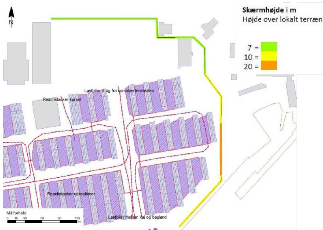
Støjvæggens højder ved Holsteinsvej og Norgesgade
